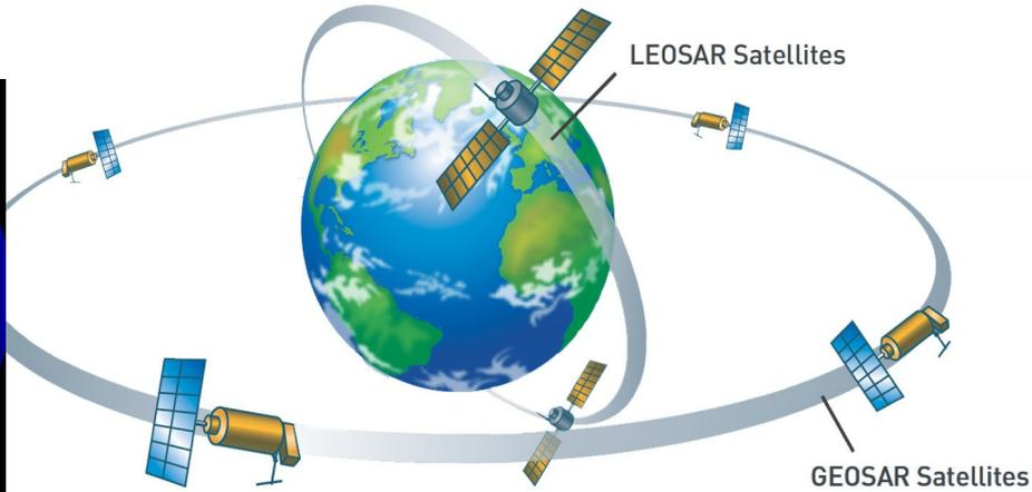
**COSPAS-SARSAT**, geostationäre und polumlaufende Satelliten zum Empfang der Notrufe einer EPIRB
